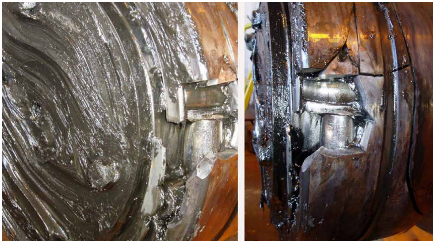
De tijdige vervanging van dit lager in de motor van een oven/droger bleek duidelijk geen overbodige luxe
