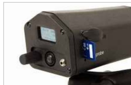
Smörjdata kan lagras på SD-kortet
