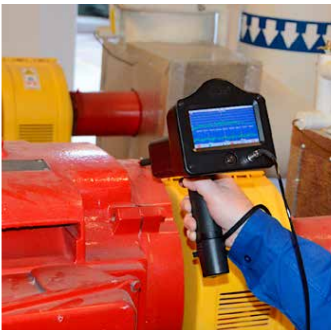
Exemple de diagnostic de roulement moteur via la technologie des ultrasons / Appareil de type Ultraprobe UP15.000 – UESystems.
