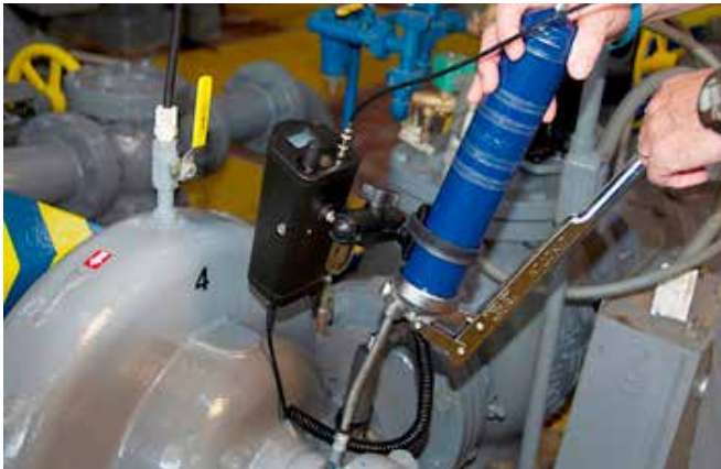
Exemple d'utilisation de la technologie des ultrasons lors d'une opération de graissage / Appareil de type GreaseCaddy UP401 – UESystems
