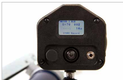
Wyświetlacz LED i pokrętko nastawy czułości
