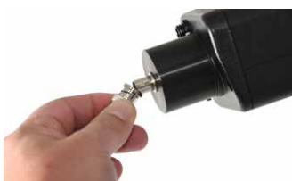
Stap 3 – Verbind een Ultraprobe met de box
