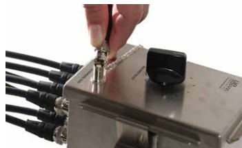
Stap 2 – Verbind de sensoren met de switch box
