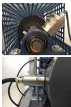
Exemples de capteurs ultrasons installés sur paliers Capteurs RAS et UT750 - UESystems
