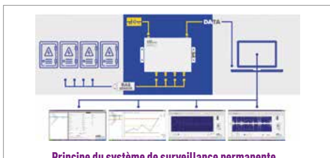
Principe du système de surveillance permanente par ultrasons d'installations électriques - 4site UESystems
