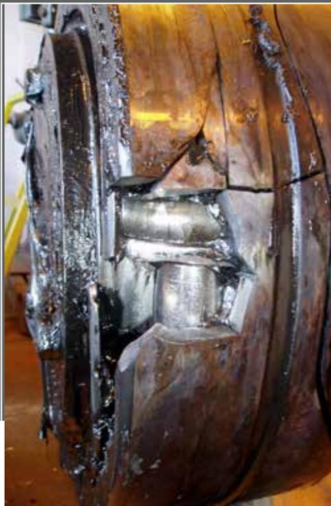
*A seguito dei risultati ottenuti con l'ispezione ultrasonora, un campione di grasso è stato prelevato per confermare la presenza o meno di un danneggiamento; in questo caso, il campione di grasso avrebbe mostrato la presenza di contaminazione metallica*
