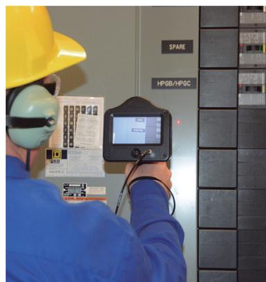
lizar para inspecciones en equipos de bajo, medio y alto voltaje. Sin embargo, el efecto corona solo se detectará en componentes que tengan al menos 1.000 voltios. A 1.000 voltios y más, el aire se convierte en un conductor y el efecto corona se escucha como un zumbido constante. La arborescencia eléctrica puede describirse como un
