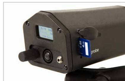
Données de Lubrification enregistrées sur carte SD
