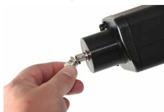
Étape 3 : Connecter l'Ultraprobe au boîtier de connexion
