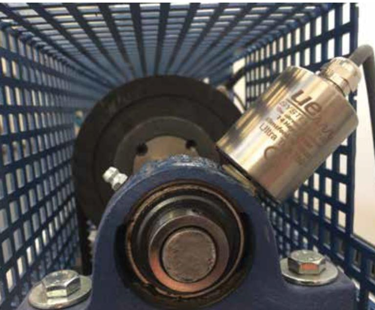
Capteur UESystems monté sur palier
