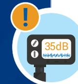
**35 dB** über der Baseline steht für kritische Schäden - **das Lager steht kurz vor dem Ausfall**
