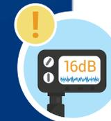
**16 dB** über der Baseline steht für beginnende optische Schäden im Lager - **ein Problem das durch Abschmieren nicht mehr zu beheben ist**
