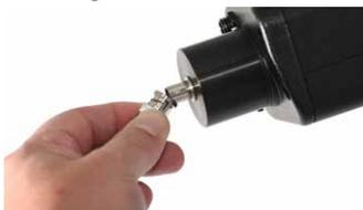
Schritt 3 - Schliessen Sie den Ultraprobe an die Switch Box an
