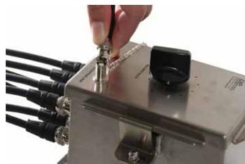
Schritt 2 - Verbinden Sie den Sensor mit der Switch Box
