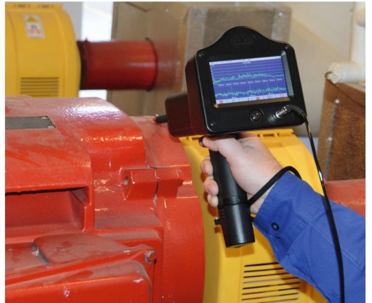
Die vorausschauende und proaktive Inspektion von rotierendem Equipment und Maschinen mithilfe von Ultraschall bietet viele Vorteile. Unter anderem lassen sich damit Produktionsausfälle verhindern, indem man Lagerausfällen vorbeugt und Schmierprobleme vermeidet.
