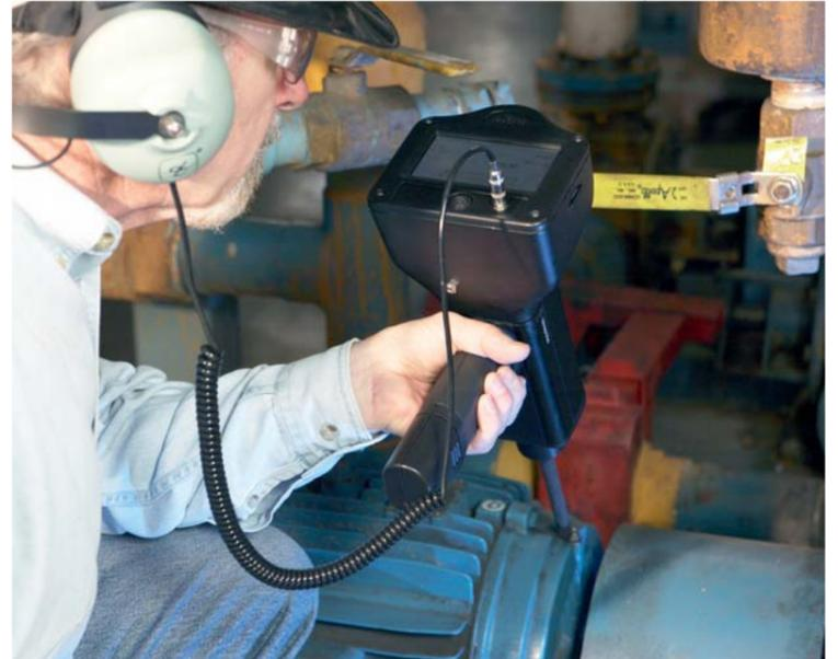
Durch die Umwandlung von hochfrequenten Geräuschen in hörbare Geräusche ermöglichen Ultraschallmessgeräte es dem Benutzer, Probleme an Wälzlager zu hören, zu sehen und zu diagnostizieren. Mithilfe der ultraschallunterstützten Schmierung können die Standzeiten von Wälzlager und Maschinen verlängert sowie Ausfälle aufgrund von Über- und Unterschmierung eliminiert werden. Bilder: UE Systems
