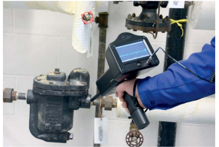
Der Prüfer muss den Typ des Kondensomaten kennen. Dadurch wird nämlich festgelegt, wie sich der Kondensatableiter anhören soll, wenn der Kontakt mit dem Ultraschallgerät hergestellt wurde. Bei der Kondensatableiterinspektion ist Geduld gefragt, denn es kann sein, dass es mehrere Minuten dauert, bis ein Kondensomat ableitet/zirkuliert. Bild: UE Systems
