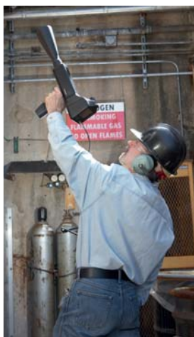
Mittels Ultraschall können Ausfälle von Anlagenteilen wie Wälzlagern und Motoren vermieden werden, da eventuell vorhandene Probleme frühzeitig erkannt werden. So reduzieren sich ungeplante Ausfallzeiten.
