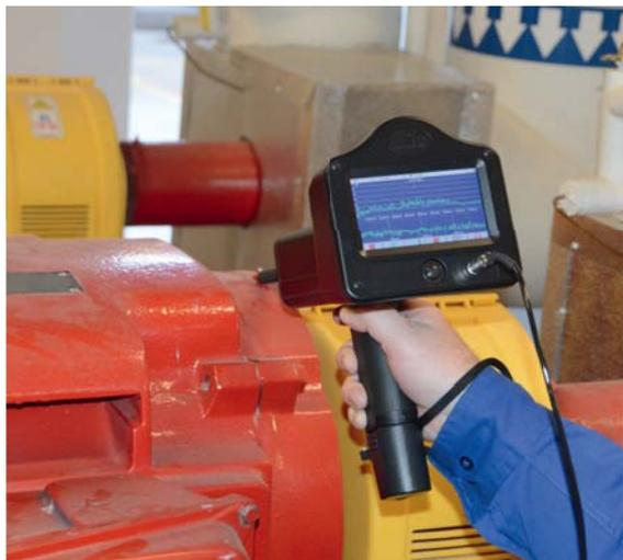
Es ist zwingend notwendig, weg von einer reaktiven und hin zu einer vorausschauenden oder zustandsorientierten Instandhaltung zu kommen. Dabei können Investitionen in vorausschauende Technologien wie Ultraschall, Schwingungsanalyse, Infrarot-Thermografie, Laserausrichtung und Motorschaltkreisanalyse ein enormes Kosteneinsparpotenzial erschließen, zumal sich die Ausgaben für derartige Geräte in überschaubaren Rahmen halten.
