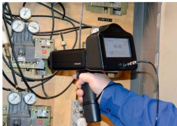
Ein Ultraschallgerät ist ein vielseitiges Werkzeug, das beispielsweise beim Energieeinsparen unterstützen kann, indem es das Auffinden und Reparieren von Druckluft- und Gaslecks sowie das Reparieren oder Austauschen ausgefallener oder defekter Kondensatableiter deutlich erleichtert. Ebenso können die Lebensdauer von Anlagenteilen wie Wälzlagern und Motoren verlängert und somit katastrophale Ausfälle vermieden werden, wodurch die Betriebszeit erhöht und ungeplante Ausfallzeiten reduziert werden.
