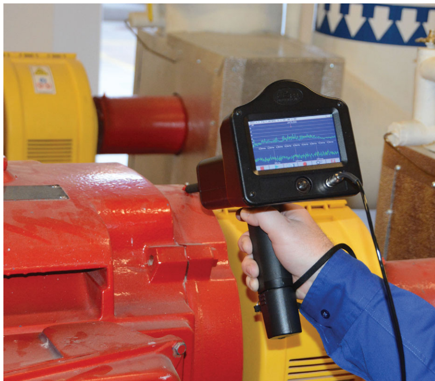
Fot. Inspekcja łożysk przy użyciu Ultraprobe 15000 firmy UE Systems
