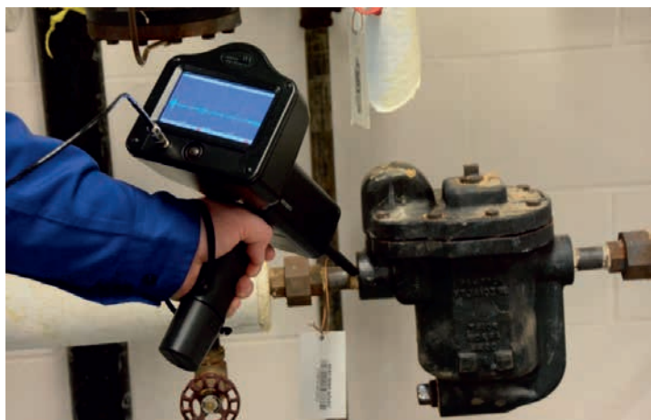
De Ultraprobe 15.000 helpt besparen door detectie van perslucht- en stoomlekkages, falende lagers en defecte elektrische installaties
