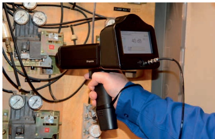
De Ultraprobe 15.000 helpt besparen door detectie van perslucht- en stoomlekkages, falende lagers en defecte elektrische installaties
