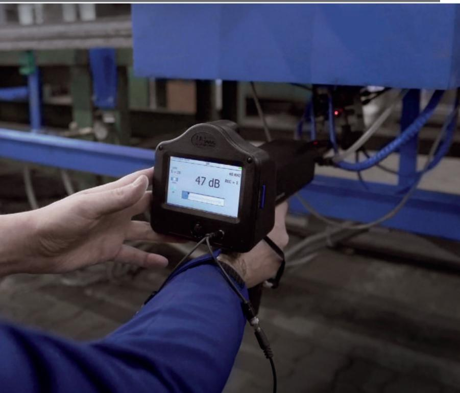
minare se ci sia abbastanza turbolenza da produrre ultrasuoni "rilevabili" per trovare una perdita.
